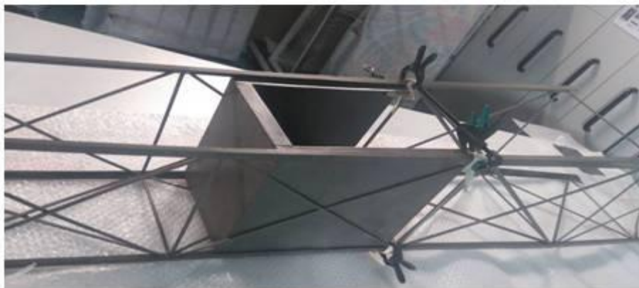
Colocación de gatos de sujeción hasta el secado de las 4 cuñas.
