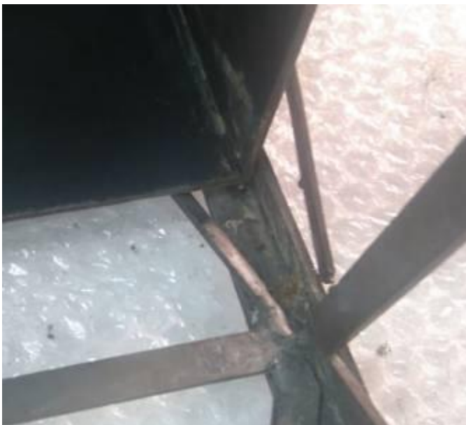
Acumulación de restos de cera, depósitos de oxido, pátina alterada
