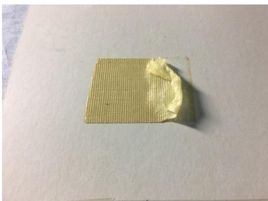
Eliminación de la cinta de doble cara con aire caliente.
