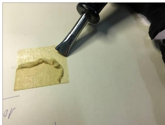
Eliminación de la cinta de doble cara con aire caliente.
