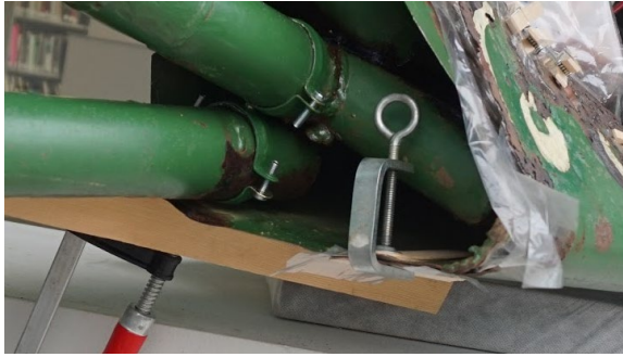
Fijaciones de las soldaduras frías de la parte inferior de la cara a la cabeza
