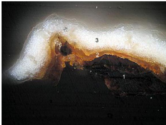
CAJ-1b, corte transversal, 300 X
